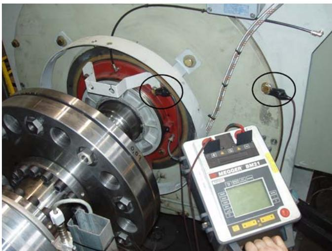
图 7-4 滚柱轴承绝缘电阻的测量
