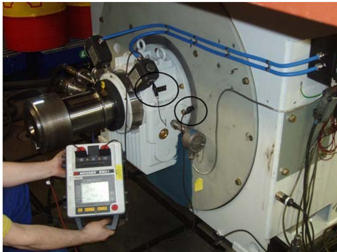
图 7-3 套筒轴承绝缘电阻的测量
